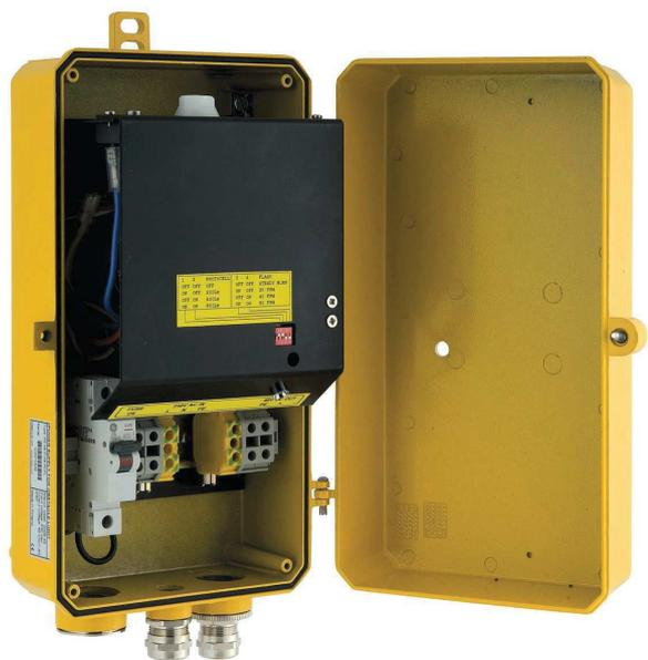
Le coffret PS permet l'alimentation électrique des différentes balises. Alimenté en 230 ou 115 VAC, il redistribue en sortie 6, 12, 24 ou 48VDC selon les modèles
